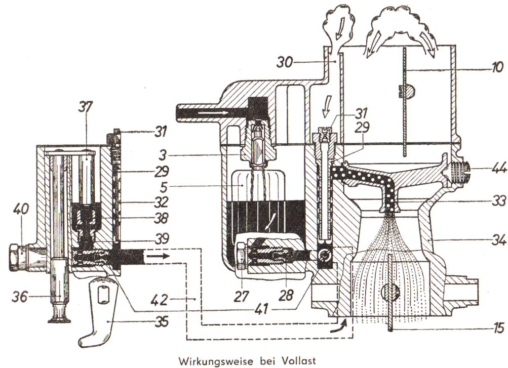
Beim Schließen der Drosselklappe (15) bewegt sich der Stößel (37) nach oben und die Ventilmadel (39) des Anreicherungsventils (38) sperrt die Kraftstoffzufuhr zur Hochleistungsdüse (41).
