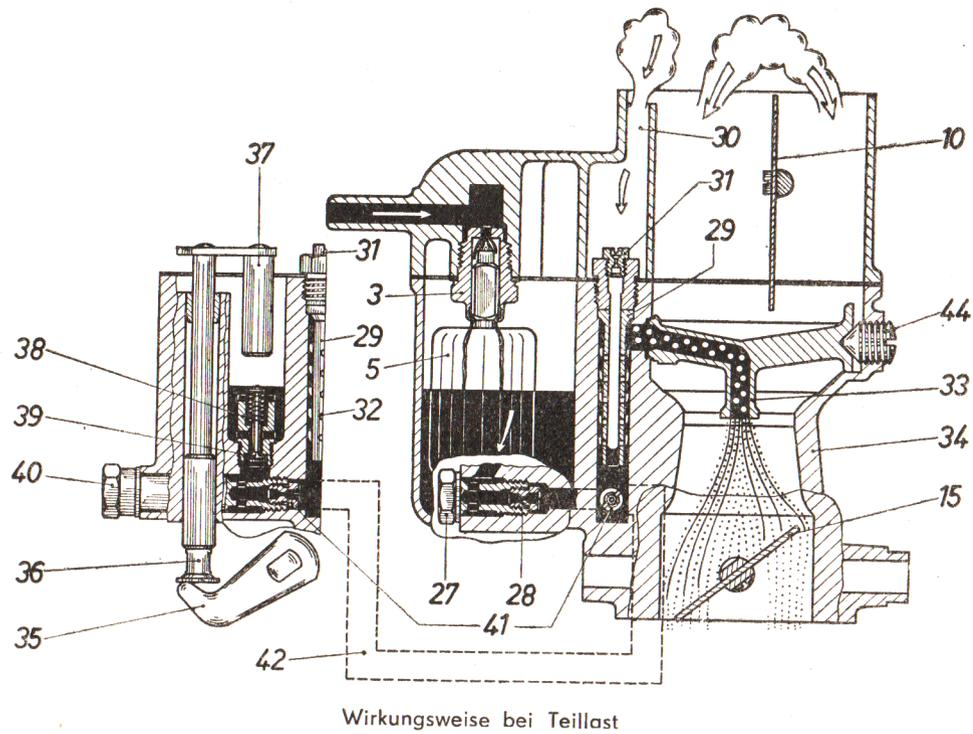
Durch das Öffnen der Drosselklappe (15) entsteht im Lufttrichter (34) ein Unterdruck, der sich auf den Mittelzerstäuber (33) überträgt und dort den von der Hauptdüse (28) dosierten Kraftstoff absaugt.
